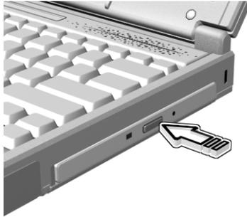
Quando a corrente está desligada, pode ejectar o tabuleiro da unidade utilizando o orifício de ejecção de emergência. Consultar página 115.
