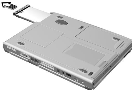
4. Introduza o módulo novo do disco rígido no compartimento do disco rígido e aperte os respectivos parafusos.
