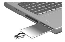
Para remover a Placa Inteligente (SmartCard), prima o Botão de ejecção de Placa Inteligente (a) e remova a Placa Inteligente (b) como se mostra na figura seguinte.
