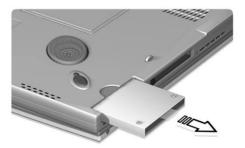
4 Introduza um módulo novo do disco rígido no compartimento do disco rígido e aperte o respectivo parafuso.
