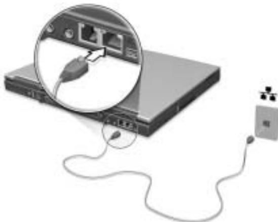
Budete-li chtít použít zabudované připojení k počítačové síti, připojte kabel sítě Ethernet ze zásuvky na zadní straně počítače do zásuvky počítačové sítě nebo do rozbočovače ve Vaší počítačové síti.
