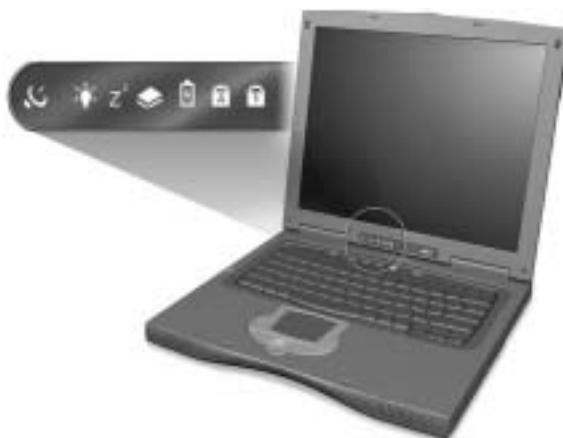
Stavové ikony „napájení“ (Power) a „spánek“ (Sleep) jsou viditelné dokonce i po zavření krytu displeje, takže stav počítače můžete sledovat i při uzavřeném krytu.
