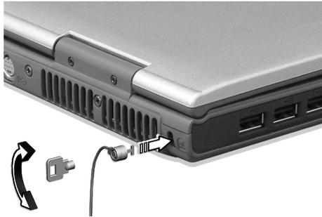
Enroulez le câble du cadenas de sécurité pour ordinateur autour d'une table, de la poignée d'un tiroir verrouillé, ou de tout autre objet fixe. Insérez le cadenas dans l'encoche et tournez la clef pour verrouiller le cadenas. Certains modèles ne possèdent pas d'encoche.
