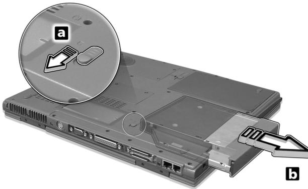
Insérez ensuite le module AcerMedia en option dans la baie AcerMedia jusqu'à ce qu'il se mette en place avec un déclic.
