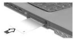
Drücken Sie zum Entfernen der SmartCard erst auf die SmartCard (a) und entfernen die SmartCard (b) dann wie in der Abbildung unten gezeigt.
