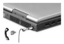
Binden Sie ein Diebstahlsicherungskabel an ein unbewegliches Objekt wie einen Tisch oder einen Griff einer abgeschlossenen Schublade. Stecken Sie das Schloß in den Anschluß für die Diebstahlsicherung, und schließen Sie dieses ab. Es gibt auch Modelle auch Schloß.
