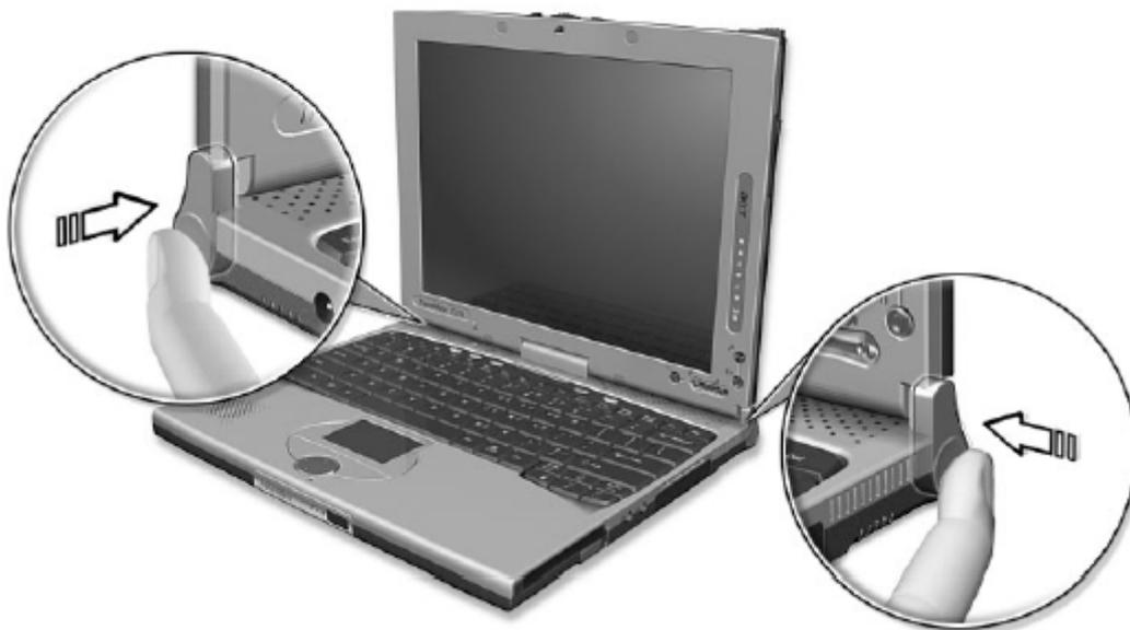
3. Поверните дисплей на 180° по часовой стрелке как показано на рисунке. Убедитесь, что дисплей выровнен относительно кнопок фиксации экрана.
