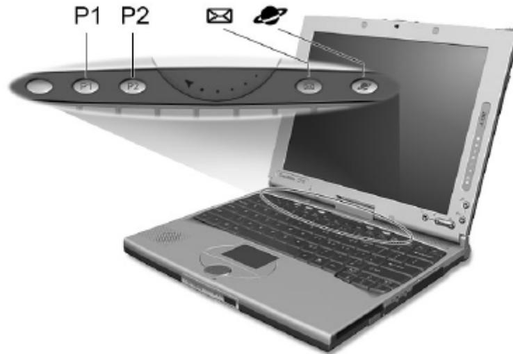
**Примечание:** слева от этих четырех клавиш быстрого запуска расположена кнопка InviLink
