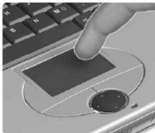
**! Внимание !** Если Вы используете внешнее указательное устройство, то внутреннюю сенсорную панель можно отключить нажатием клавиши Fn-F7.
