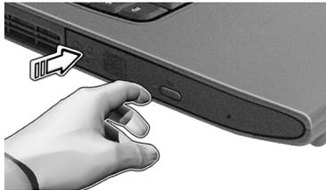
Wenn der Computer ausgeschaltet ist, können Sie den Laufwerksträger über den Notauswurf ausfahren. Siehe Seite 67.
