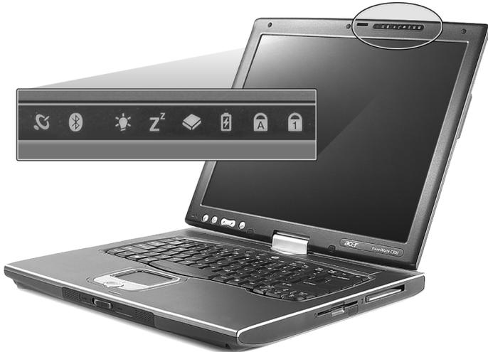
Die Statussymbole für die Stromversorgung und den Sleep-Modus sind auch bei geschlossener Display-Abdeckung sichtbar, damit Sie den Status des Computers auch erkennen können, wenn die Abdeckung geschlossen ist.
