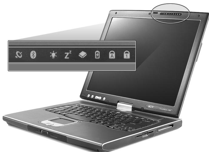
Le icone di stato relative alla modalità alimentazione (Power) e sospensione (Sleep) sono visibili anche quando il coperchio del display è chiuso, al fine di consentire il controllo continuo dello stato del computer.
