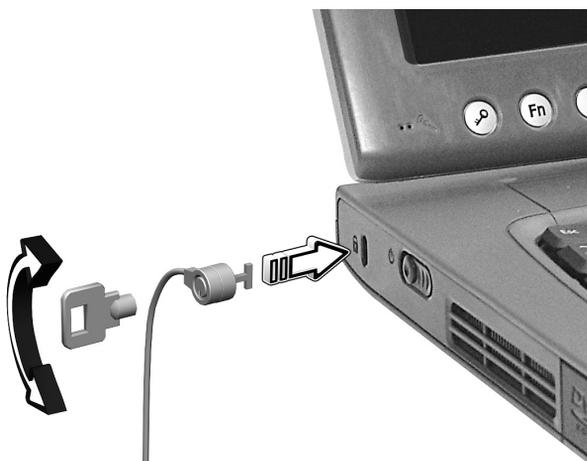
Avvolgere un cavo di blocco di sicurezza per il computer intorno ad un oggetto fisso, ad esempio un tavolo o la maniglia di un cassetto chiuso a chiave. Inserire la serratura nel foro e girare la chiave per fissare il blocco. Sono disponibili anche modelli senza chiave.
