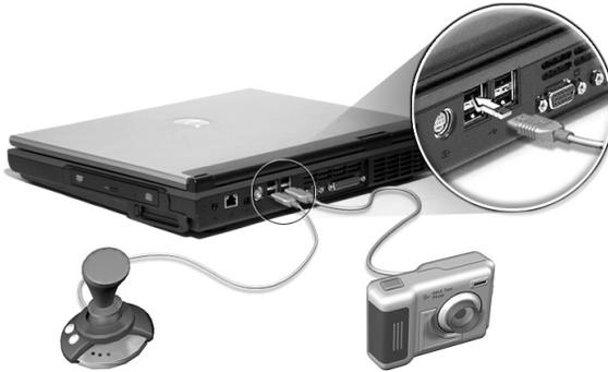
O padrão USB é Plug-and-Play, o que significa que é possível ligar e começar a utilizar um dispositivo USB sem ter que reiniciar o computador. Pode-se também desligar o dispositivo a qualquer instante.
