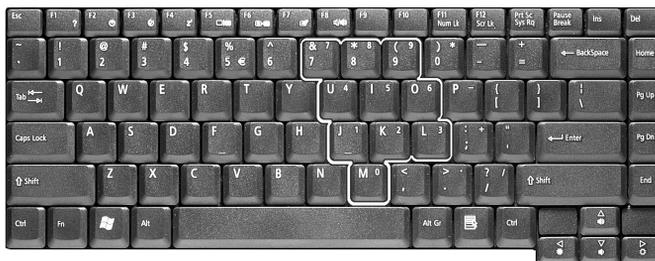
Para usar as teclas numéricas integradas, active a função Num Lk premindo as teclas Fn + F11 simultaneamente.
