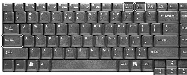
O computador possui três teclas de bloqueio, cada uma com sua luz de indicação de estado.
