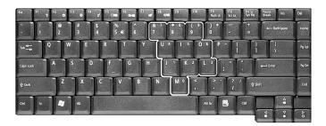
Para usar el teclado numérico integrado, active Num Lock pulsando Fn + F11 simultáneamente.
