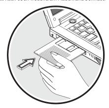
Die Diskette rastet ein und die Auswurftaste des Diskettenlaufwerks springt hervor. So nehmen Sie eine Diskette aus dem Diskettenlaufwerk heraus:
