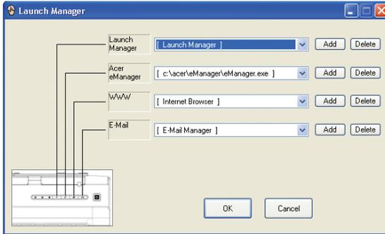
Launch Manager permite definir los cuatro botones de lanzamiento fácil situados en la parte superior del teclado. Vea la sección **"Botones de lanzamiento fácil"** en la **página 10** para determinar su ubicación.
