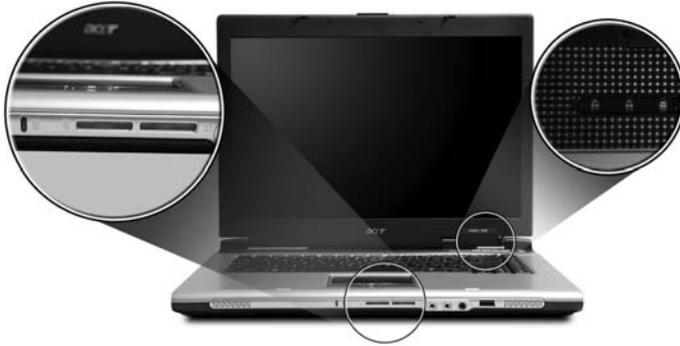
Los indicadores de estado de encendido/apagado, Batería y Comunicación inalámbrica pueden ser vistos con la pantalla LCD cerrada.
