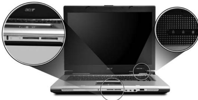
Индикаторы состояния "Питание", "Аккумулятор" и "Беспроводная связь" видны даже при закрытой крышке ЖК-дисплея.
