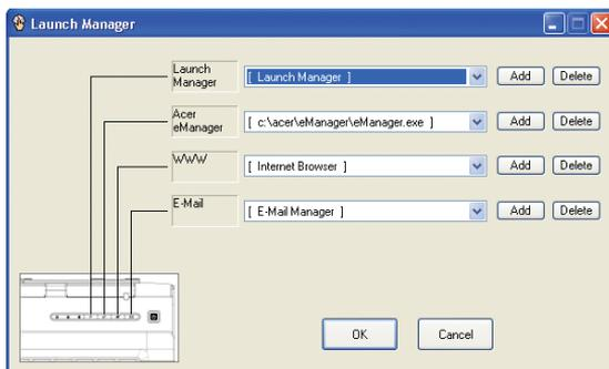
Программа Launch Manager позволяет задавать действия для четырех кнопок быстрого запуска, расположенных над клавиатурой. См. "**Кнопки быстрого запуска**" на стр. 10, где показано расположение кнопок быстрого запуска. Запустить программу Launch Manager можно, нажав кнопку **Пуск - Все программы** и выбрав **Launch Manager**.
