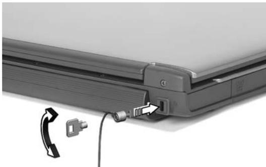
Обмотайте кабелем замка безопасности для компьютеров неподвижный предмет, например, стол или ручку запертого ящика. Вставьте замок в выемку и поверните ключ, чтобы запереть замок. Бывают и модели замков без ключей.
