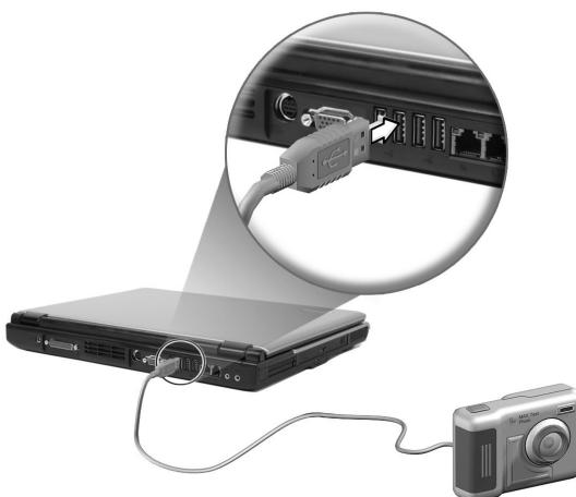
To USB είναι σύνδεση και εκτέλεσης (plug and play), που σημαίνει πως μπορείτε να συνδέσετε και να αρχίσετε να χρησιμοποιείτε μια συσκευή USB δίχως να πρέπει να επανεκκινήσετε τον υπολογιστή σας. Μπορείτε επίσης να αποσυνδέστε τη συσκευή οποιαδήποτε στιγμή.
