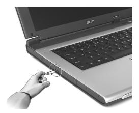
Wenn der Computer ausgeschaltet ist, können Sie den Laufwerkträger über den Notauswurf ausfahren. Siehe Seite 66.
