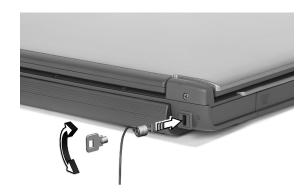
Binden Sie ein Diebstahlsicherungskabel an ein unbewegliches Objekt wie einen Tisch oder einen Griff einer abgeschlossenen Schublade. Stecken Sie das Schloß in den Anschluß für die Diebstahlsicherung, und schließen Sie dieses ab. Es gibt auch Modelle ohne Schloß.
