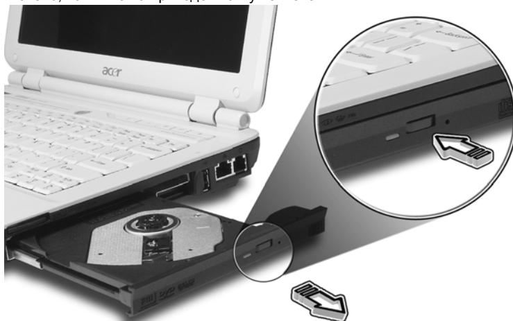
При отключенном питании лоток привода можно открыть, вставив тонкий стержень в отверстие аварийного извлечения.
