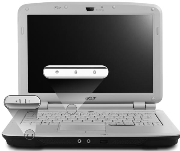
Индикаторы на передней панели видны даже при закрытой крышке компьютера.
