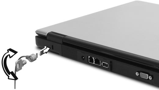
Enrole um cabo de bloqueio de segurança do computador em torno de um objecto imóvel, como por exemplo uma mesa ou o puxador de uma gaveta fechada. Introduza o bloqueio na ranhura da chave de protecção de segurança e rode a chave para proteger o bloqueio. Também estão disponíveis modelos sem chave.
