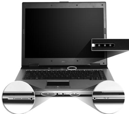
Os indicadores de estado Liga-desliga, Bateria e Comunicação sem fios podem ser vistos mesmo com o ecrã de cristal líquido fechado.
