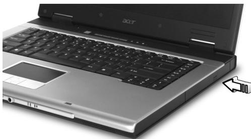
Com a energia desligada, pode-se ejectar o tabuleiro da unidade utilizando o furo de ejeção de emergência.
