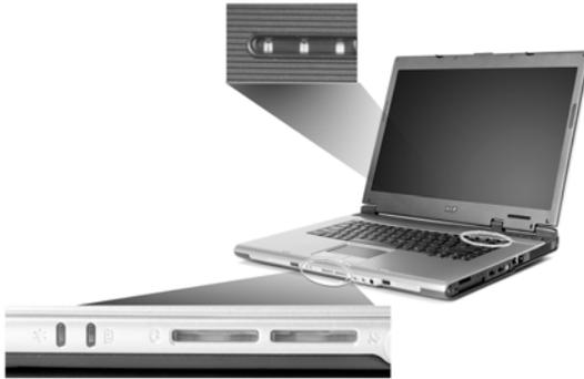
Los indicadores de estado de encendido/apagado, Batería y Comunicación inalámbrica pueden ser vistos con la pantalla LCD cerrada.
