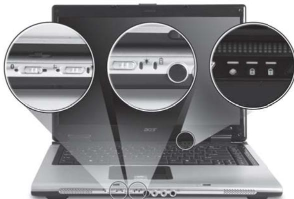
Stavové indikátory na předním panelu jsou viditelné i po zavření víka počítače.
