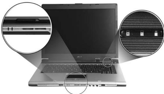
Gli indicatori di alimentazione, batteria e collegamento wireless sono visibili anche quando il display LCD è chiuso.
