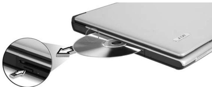
Quando è spento, è possibile espellere il vassoio del drive utilizzando il foro di apertura di emergenza.
