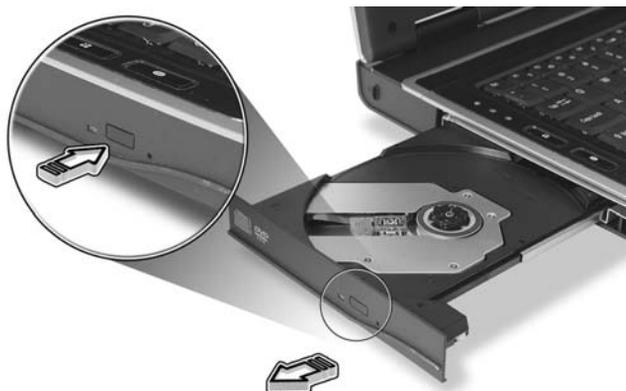
Com a alimentação desligada, é possível ejectar o tabuleiro da unidade utilizando o furo de ejeção de emergência.
