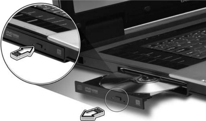
Wenn der Computer ausgeschaltet ist, können Sie den Laufwerksträger mit Hilfe des mechanischen Auswurflochs herausfahren.
