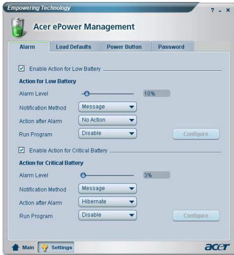
Si può anche definire un allarme livello critico della batteria, e se il sistema deve passare alla modalità di Standby o Ibernazione.
