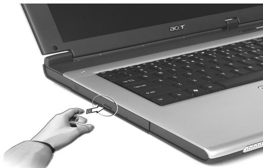
При отключенном питании вы можете вытащить лоток дисководов с помощью отверстия выброса при аварийных случаях. См. стр. 52.
