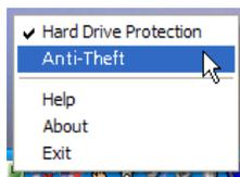
Если включить эту функцию, то при перемещении вашего ноутбука зазвучит сигнал тревоги. Для предотвращения несанкционированного доступа эта функция защищена паролем.
