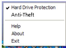
Если включить эту функцию, то головки жесткого диска будут "запаркованы", когда система обнаружит превышение допустимого для жесткого диска уровня вибрации или движения.
