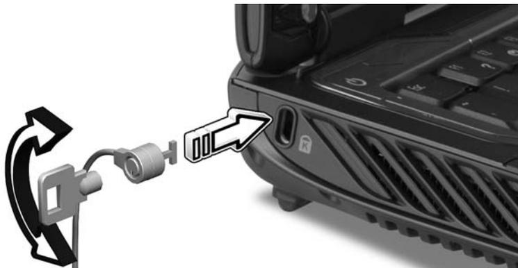
Обмотайте кабелем замка безопасности для компьютеров неподвижный предмет, например, стол или ручку запертого ящика. Вставьте замок в выемку и поверните ключ, чтобы запереть замок. Бывают и модели замков без ключей.
