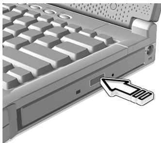
Quando a corrente está desligada, pode ejectar o tabuleiro da unidade utilizando o orifício de ejecção de emergência. Consultar página 54.
