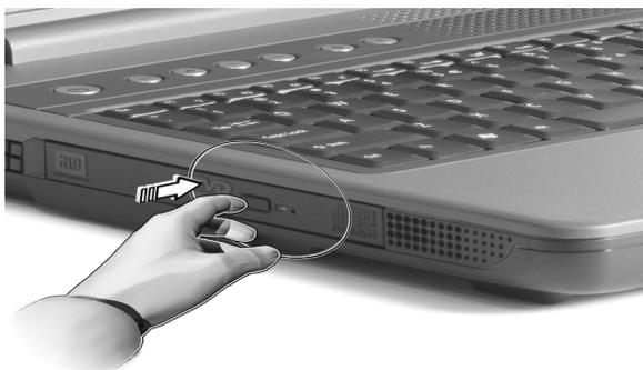
Quando il computer è spento, è possibile espellere il vassoio dell'unità utilizzando il foro di espulsione di emergenza. Vedere pagina 46.
