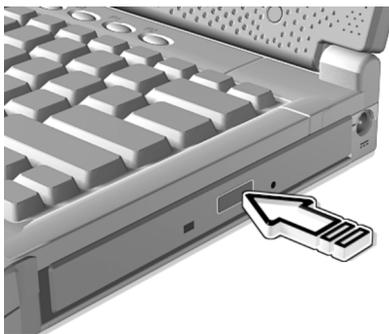
Pokud je napájení počítače vypnuté, můžete "šuplík" mechaniky vysunout pomocí nouzového otvoru pro vysunutí. Viz stránka 46.
