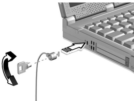
Obepněte kabel bezpečnostního zámku počítače kolem nepohyblivého objektu, jako je například stůl nebo držadlo uzamčené stolní zásuvky. Vložte zámek do výřezu a otočte klíčkem, aby se zámek zajistil.
