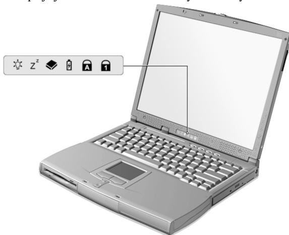
Stavové ikony "napájení" (power) a "spaní" (sleep) jsou viditelné dokonce i po zavření krytu displeje, takže stav počítače můžete sledovat i při uzavřeném krytu.
