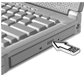
Quando il computer è spento, è possibile espellere il vassoio dell'unità utilizzando il foro di espulsione di emergenza. Vedere pagina 50.
