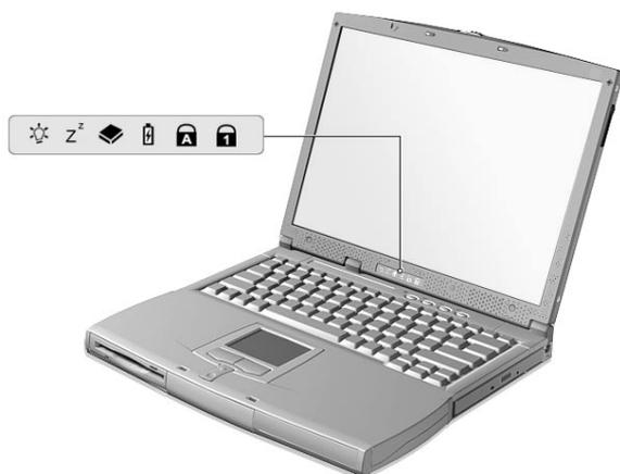
Le icone di stato relative alla modalità alimentazione (Power) e sospensione (Sleep) sono visibili anche quando il coperchio del display è chiuso, al fine di consentire il controllo continuo dello stato del computer.
