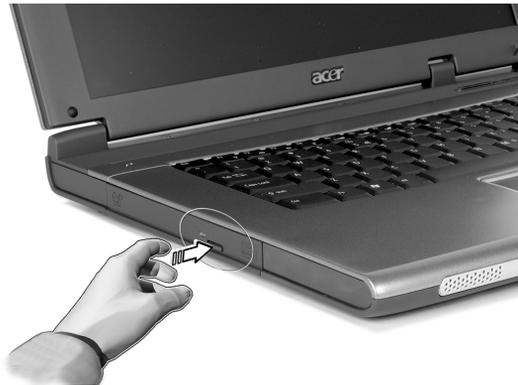
Wenn der Computer ausgeschaltet ist, können Sie den Laufwerkträger über den Notauswurf ausfahren. Siehe Seite 56.
