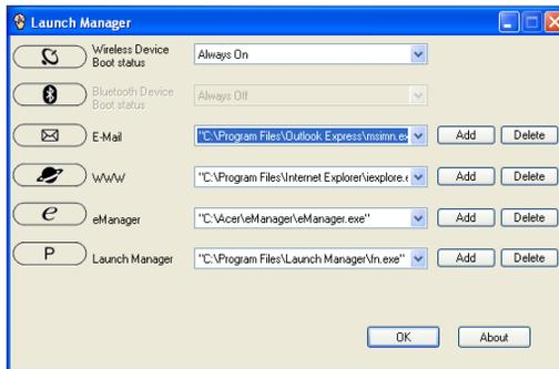
Программа Launch Manager позволяет задавать действия для четырех кнопок быстрого запуска, расположенных над клавиатурой. См. **"Кнопки быстрого запуска"** на стр. 9, где показано расположение кнопок быстрого запуска.
