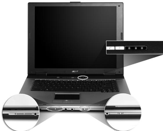
Индикаторы состояния "Питание", "Аккумулятор" и "Беспроводная связь" видны даже при закрытой крышке ЖК-дисплея.
