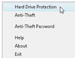
Esta função, estando seleccionada, interrompe todas as transacções de dados para o disco rígido no caso de ser detectado qualquer movimento ou vibração que ultrapasse o nível tolerado pelo disco rígido.
