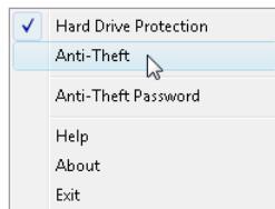
Если включить эту функцию, то при перемещении вашего ноутбука зазвучит сигнал тревоги. Для предотвращения несанкционированного доступа эта функция защищена паролем.
