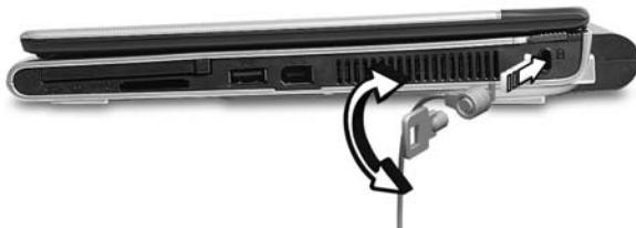
Обмотайте кабелем замка безопасности для компьютеров неподвижный предмет, например, стол или ручку запертого ящика. Вставьте замок в выемку и поверните ключ, чтобы запереть замок. Бывают и модели замков без ключей.
