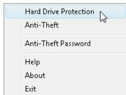
Включение этой функции приводит к приостановке обмена данными с жестким диском при обнаружении вибраций или перемещения, превышающих уровень, допустимый для правильной работы жесткого диска.
