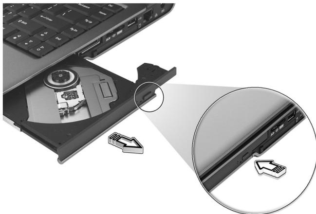
Quando a corrente está desligada, pode ejetar o tabuleiro da unidade utilizando o orifício de ejeção de emergência. Consultar página 52.
