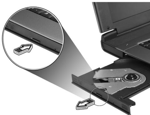
Wenn der Computer ausgeschaltet ist, können Sie den Laufwerksträger mit Hilfe des mechanischen Auswurflochs herausfahren.
