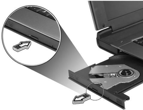
Con el ordenador apagado, puede expulsar la bandeja de la unidad mediante el orificio de expulsión de emergencia.
