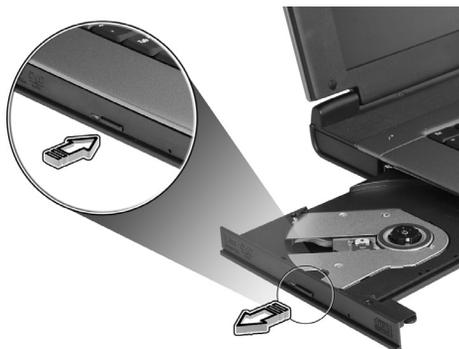
Com a alimentação desligada, é possível ejectar o tabuleiro da unidade utilizando o furo de ejeção de emergência.
