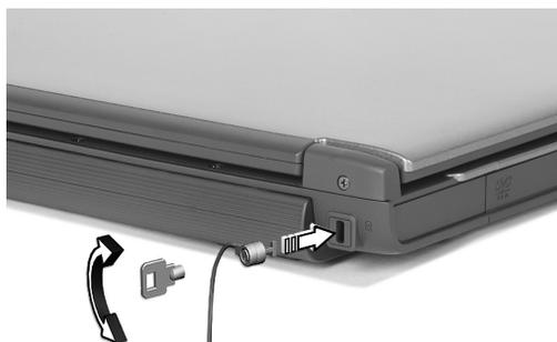
Enrole um cabo de bloqueio de segurança do computador em torno de um objecto imóvel, como por exemplo uma mesa ou o puxador de uma gaveta fechada. Introduza o bloqueio na ranhura da chave de protecção de segurança e rode a chave para proteger o bloqueio. Também estão disponíveis modelos sem chave.
