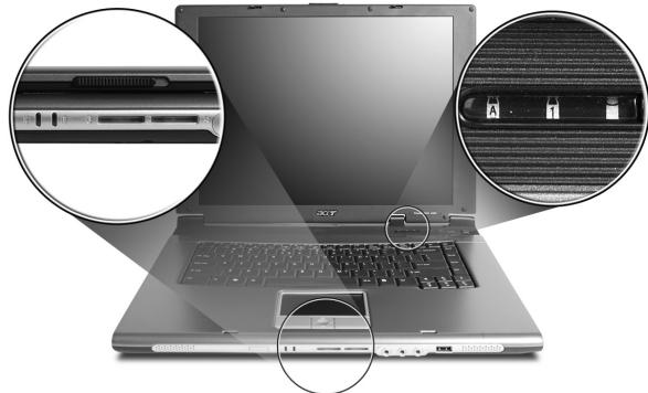
Индикаторы состояния "Питание", "Аккумулятор" и "Беспроводная связь" видны даже при закрытой крышки ЖК-дисплея.
