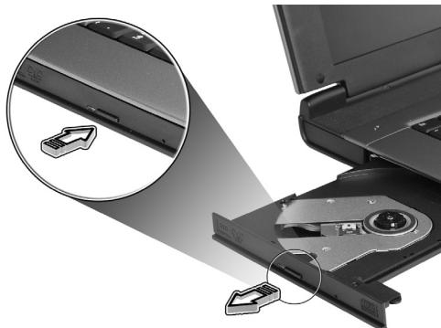
При отключенном питании лоток привода можно открыть, вставив тонкий стержень в отверстие аварийного извлечения.
