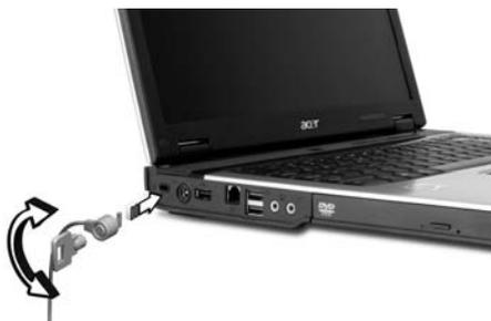
Обмотайте кабелем замка безопасности для компьютеров неподвижный предмет, например, стол или ручку запертого ящика. Вставьте замок в выемку и поверните ключ, чтобы запереть замок. Бывают и модели замков без ключей.
