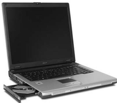
При отключенном питании лоток привода можно извлечь, вставив тонкий стержень в отверстие механического извлечения.
