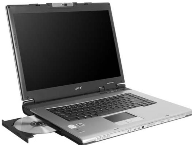
Introduzca un clip en el orificio de expulsión para expulsar la bandeja de la unidad óptica cuando el ordenador esté apagado.
