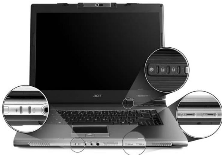
Los indicadores de estado de encendido/apagado batería y comunicación inalámbrica son visibles, aunque se cierre la pantalla LCD.
