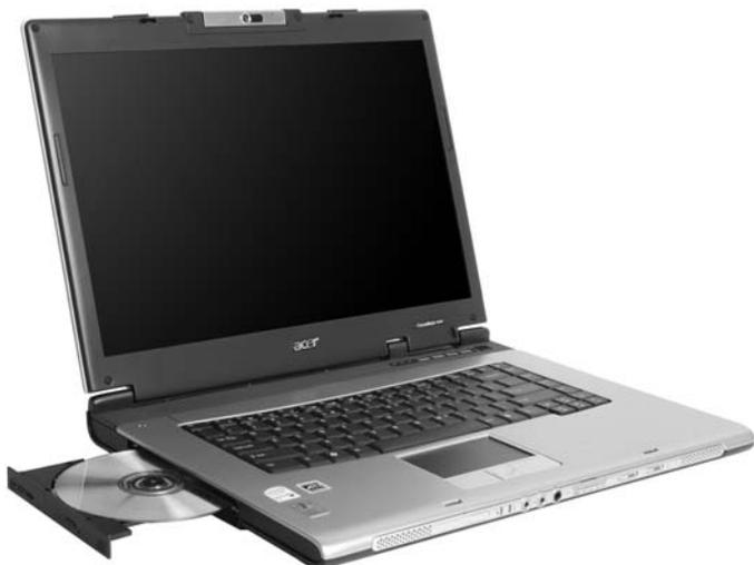
Inserire una graffetta nel foro di espulsione di emergenza e espellere il vassoio del drive ottico quando il computer è spento.
