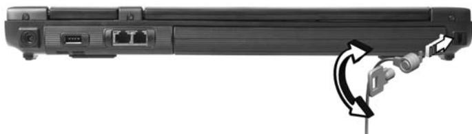
Avvolgere un cavo di sicurezza per computer intorno ad un oggetto fisso, ad esempio un tavolo o la maniglia di un cassetto chiuso a chiave. Inserire la serratura nel foro e girare la chiave per fissare il blocco. Sono disponibili anche modelli senza chiave.
