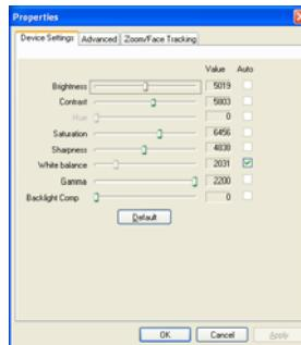
Вкладке **Device Settings** можно для камеры изменять яркость, контраст, оттенок, насыщенность, резкость и так далее.
