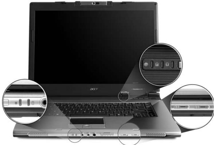
Индикаторы состояния "Питание", "Аккумулятор" и "Беспроводная связь" видны даже при закрытой крышке ЖК-дисплея.
