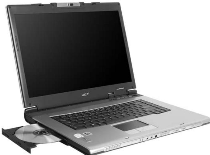
Чтобы открыть привод оптических дисков, когда компьютер выключен, вставьте скрепку в отверстие аварийного извлечения.
