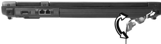
Обмотайте кабелем замка безопасности для компьютеров неподвижный предмет, например, стол или ручку запертого ящика. Вставьте замок в выемку и поверните ключ, чтобы запереть замок. Бывают и модели замков без ключей.
