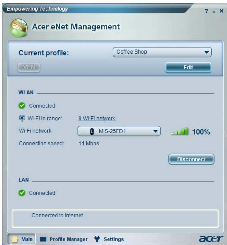
Утилита Acer eNet Management позволяет сохранять сетевые настройки для разных мест в соответствующих профилях и автоматически применяет их, когда пользователь передвигается из одного места в другое. Сохраняются такие настройки, как параметры подключения к сети (IP-адреса и параметры сервера DNS, сведения о беспроводной точке доступа и т.д.), а также стандартные настройки принтера. Из соображений безопасности утилита Acer eNet Management не сохраняет имя пользователя и его пароль.
