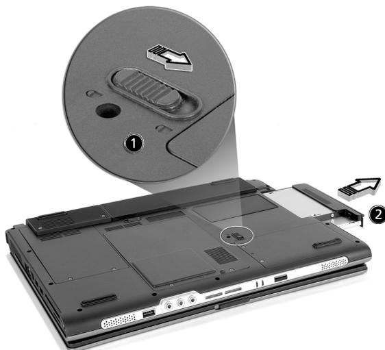
Successivamente, inserire il modulo AcerMedia opzionale nell'alloggiamento fino a farlo scattare in posizione.
