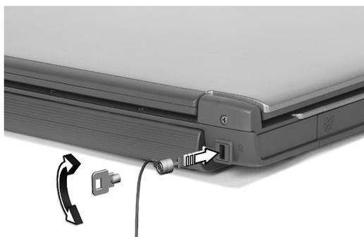
Avvolgere un cavo di blocco di sicurezza per il computer intorno ad un oggetto fisso, ad esempio un tavolo o la maniglia di un cassetto chiuso a chiave. Inserire la serratura nel foro e girare la chiave per fissare il blocco. Sono disponibili anche modelli senza chiave.
