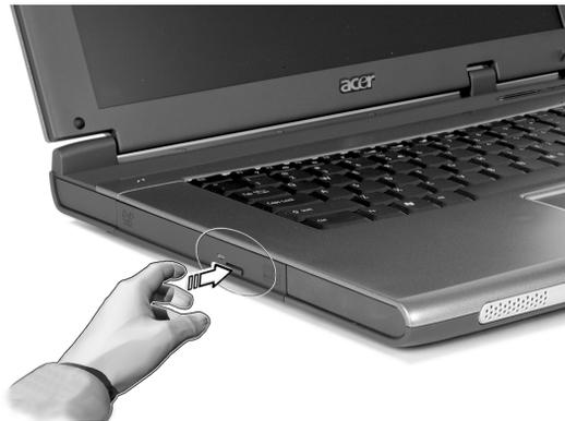
Quando il computer è spento, è possibile espellere il vassoio dell'unità utilizzando il foro di espulsione di emergenza. Vedere pagina 56.
