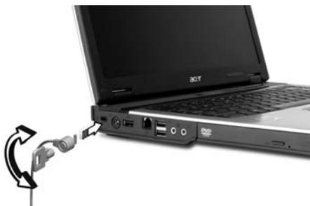
Binden Sie ein Diebstahlsicherungskabel an ein unbewegliches Objekt wie einen Tisch oder einen Griff einer abgeschlossenen Schublade. Stecken Sie das Schloß in den Anschluß für die Diebstahlsicherung, und schließen Sie dieses ab. Es gibt auch Modelle auch Schloß.
