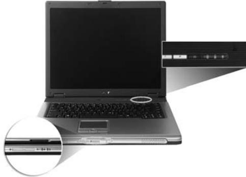
Die Statusanzeigen für Strom, Batterie und Wireless-Kommunikation sind selbst dann zu sehen, wenn die LCD-Anzeige geschlossen ist.
