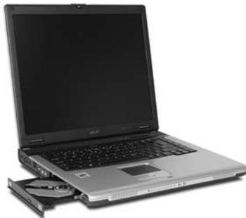
Wenn der Computer ausgeschaltet ist, können Sie das Laufwerktablett mit Hilfe des mechanischen Auswurflochs herausfahren.
