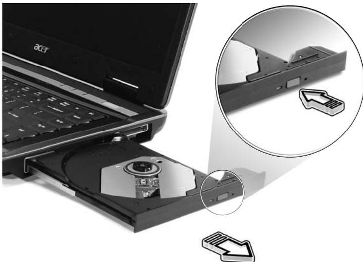
コンピュータがオフの状態の場合は、緊急用イジェクトホールにペーパークリップを差し込むと光学ドライブトレイが出てきます。
