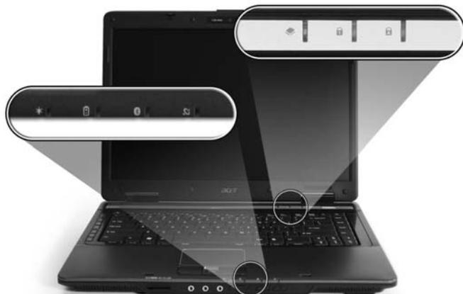
フロントパネルのインジケータは、コンピュータカバーが閉じた状態でも見えるようになっています。
