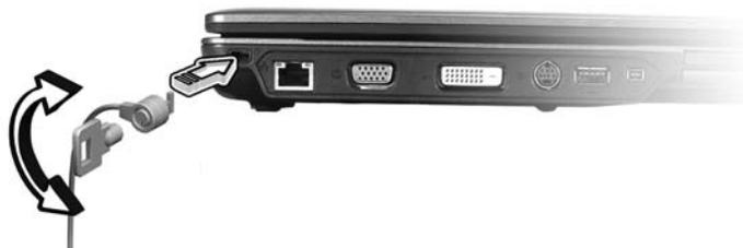
コンピューター用安全ロックのケーブルを机やロックした引き出しの取っ手などの動かないものにつなぎます。ロックをセキュリティキーロックノッチに挿入し、キーをまわしてロックを固定してください。
