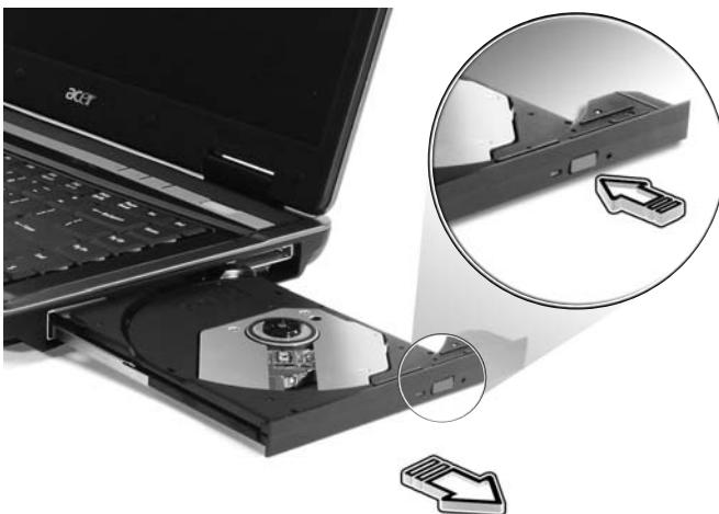
Na vypnutom počítači môžete opticú mechaniku vysunúť pomocou otvoru pohotovostného vysunutia.
