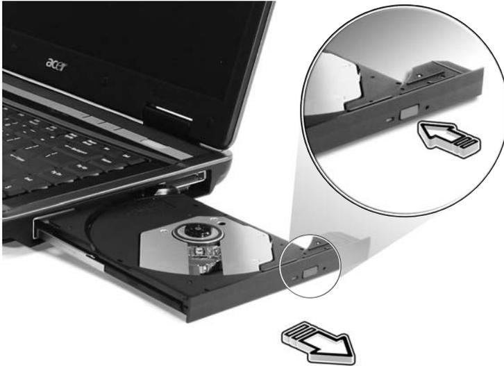
Con el ordenador apagado, puede expulsar la bandeja de la unidad mediante el orificio de expulsión de emergencia.
