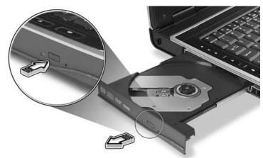
Wenn der Computer ausgeschaltet ist, können Sie den Laufwerkträger mit Hilfe des mechanischen Auswurflochs herausfahren.
