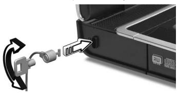
Binden Sie ein Diebstahlsicherungskabel an ein unbewegliches Objekt wie einen Tisch oder einen Griff einer abgeschlossenen Schublade. Stecken Sie das Schloss in den Anschluss für die Diebstahlsicherung, und schließen Sie dieses ab. Es gibt auch Modelle ohne Schlüssel.
