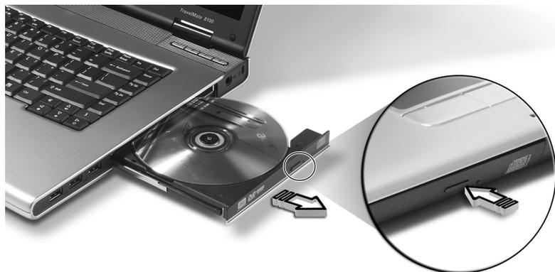
Quando a corrente está desligada, pode ejectar o tabuleiro da unidade utilizando o orifício de ejeção de emergência.
