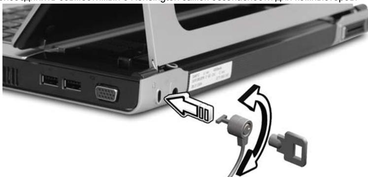
Обмотайте кабелем замка безопасности для компьютеров неподвижный предмет, например, стол или ручку запертого ящика. Вставьте замок в выемку и поверните ключ, чтобы запереть замок. Бывают и модели замков без ключей.
