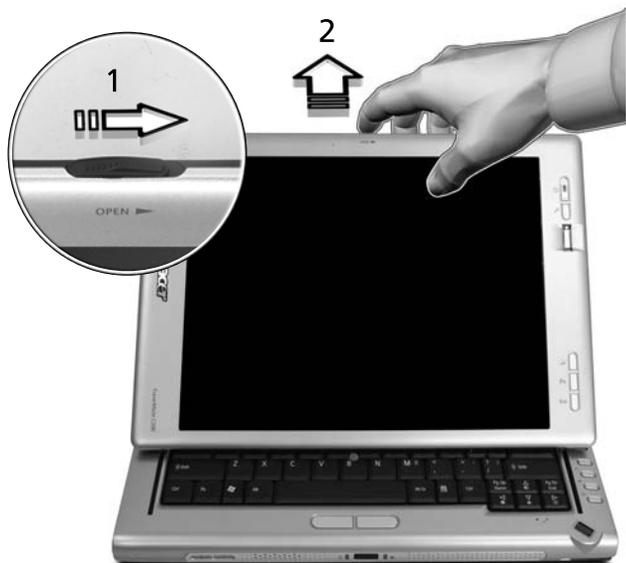
2) Аккуратно откидывайте дисплей до тех пор, пока он не зафиксируется в вертикальном положении и используйте клавиатуру для ввода данных.
